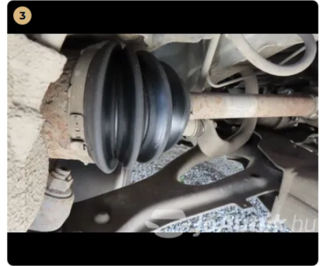
3 Futómű A féltengelyen zsíros / olajos kicsapódás nem látható.
