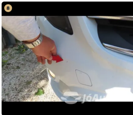
8 Külső karosszéria elemek Első vészháritón apró kavics sérülések vannak.
