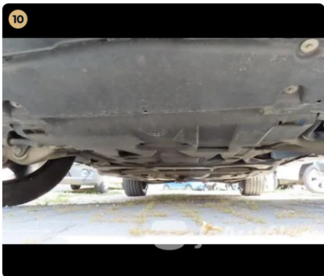
10 ✓ Utascella és gyűrődő zónák A padlólemez burkolatán javításra utaló nyomok nem láthatók.
