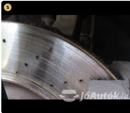
5 ! Fékrendszer A féktárcsán kezdődő vállasodás található.
