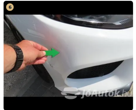
6 ! Külső karosszéria elemek Első vészháritón apró kavics sérülések.
