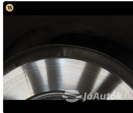
⚠ Férendszer A féktárcsán kezdődő vallasodás található. Hátsó féktárcsa enyhén vallas.
