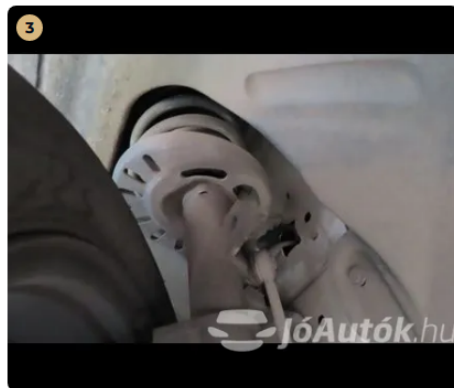
✓ Futómű A lengéscsillapítón olajfolyás nem észlelhető.
