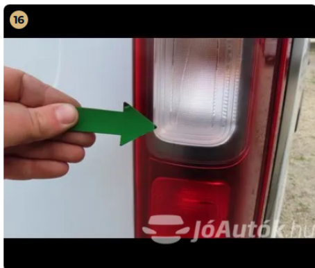
Világítás Jobb hátsó lámpán repedés.
