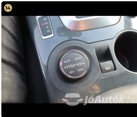
! Elektromos berendezések Üzem mód választó tekerő kapcsoló nem működik rendeltetés szerűen.
