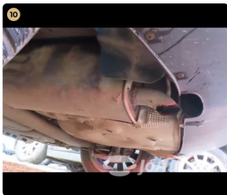
10 Motor Hátsó kipufogó dob palástja korrodált.
