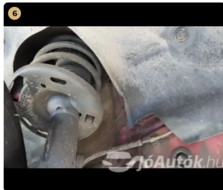
✓ Futómű A lengéscsillapítón olajfolyás nem észlelhető.
