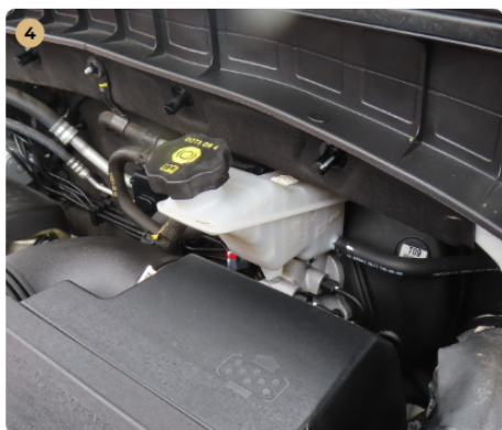
✓ Fékkrendszer A fékfolyadék színe megfelelő.
