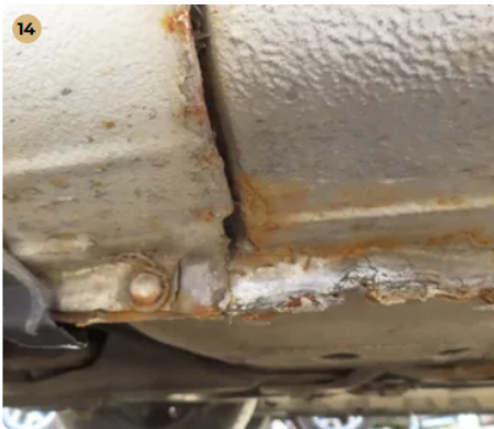
! Utascella és gyűrődő zónák Bal oldali küszöb első része korrodál.
