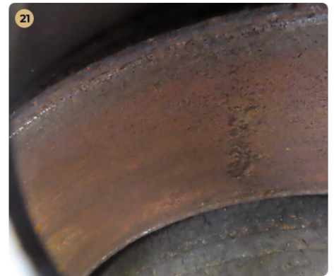
! Fékrendszer Fékek enyhén korrodáltak.
