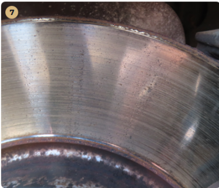
⚠ Férendszer A féktárcsán kezdődő vállasodás található. Hátsó fékbetétek kopottak.
