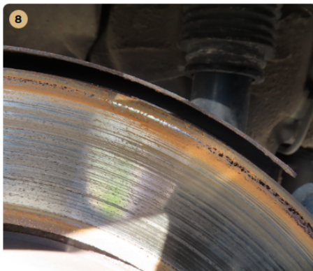
! Fékkrendszer Hátsó fékbetétek kopottak.
