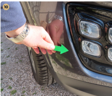
! Külső karosszéria elemek Az autó használatából eredő apró kavicsfelverődések, hajszál karcok láthatóak. Első vészháritón apró kavics sérülések vannak.
