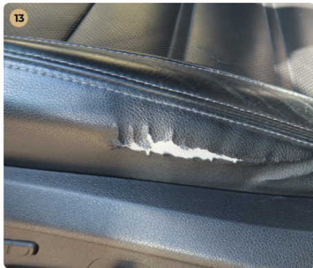
13 Kárpitozás és belső burkolatok Vezető oldali ülés oldala ki van repedve.
