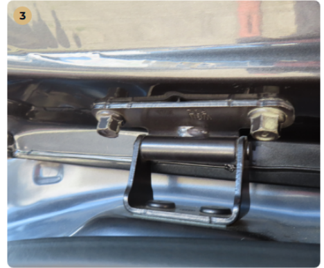
! Külső karosszéria elemek Csomagtér ajtó csavarjain megbontás jelei láthatók.
