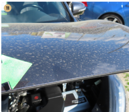
! Külső karosszéria elemek Az autó használatából eredő apró kavicsfelverődések, hajszál karcok láthatóak. Motorháztetőn kavics sérülések.
