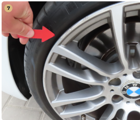
! Felnik Könnyűfém felnin patkázás nyomai láthatóak.
