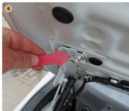
! Külső karosszéria elemek A motorháztető és a sárvédők csavarjain megbontás jelei láthatók.
