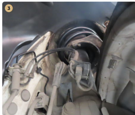
✓ Futómű A lengéscsillapítón olajfolyás nem észlelhető.
