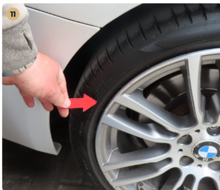
! Felnik Könnyűfém felnin patkázás nyomai láthatóak.
