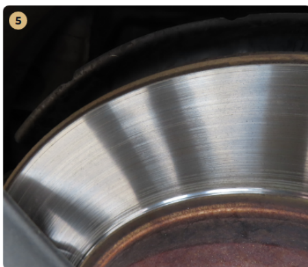
! Fékrendszer A féktárcsán kezdődő vállasodás található.
