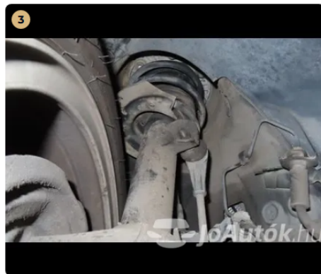
✓ Futómű A lengéscillapítón olajfolyás nem észlelhető.
