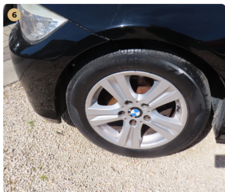
! Gumiabroncsok A gumiabroncsok odalfala repedezett.
