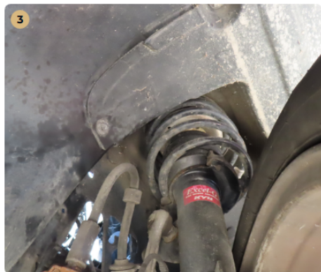
✓ Futómű A lengéscsillapítón olajfolyás nem észlelhető.
