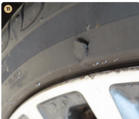
⚠ Gumiabroncsok Jobb hátsó gumiabroncs oldalja szakadt.
