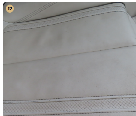
⚠ Kárpitozás és belső burkolatok Első ülések ülő lapjai kopottak.
