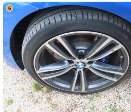
✓ Gumiabroncsok A gumiabroncsok oldalja nem repedezett.
