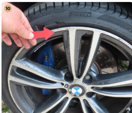
⚠ Felnik Könnyűfém felnin patkázás nyomai láthatóak.
