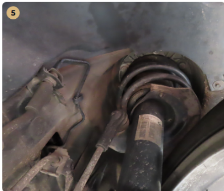
✓ Futómű A lengéscsillapítón olajfolyás nem észlelhető.
