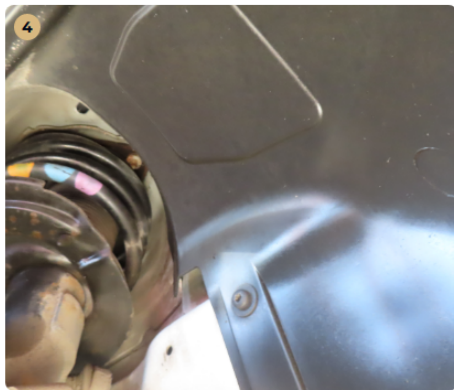
✓ Futómű A lengéscsillapítón olajfolyás nem észlelhető.
