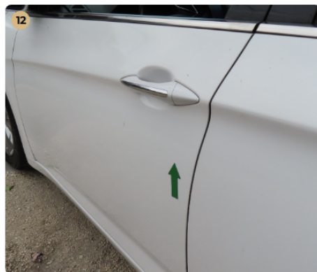
⚠ Külső karosszéria elemek Az autó használatából eredő apró kavicsfelverődések, hajszál karcok láthatóak. Apró horpadás a bal első ajtón.
