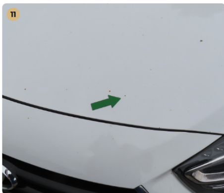
⚠ Külső karosszéria elemek Az autó használatából eredő apró kavicsfelverődések, hajszál karcok láthatóak. Motorháztetőn és a tető első részén kavics sérülések láthatók.
