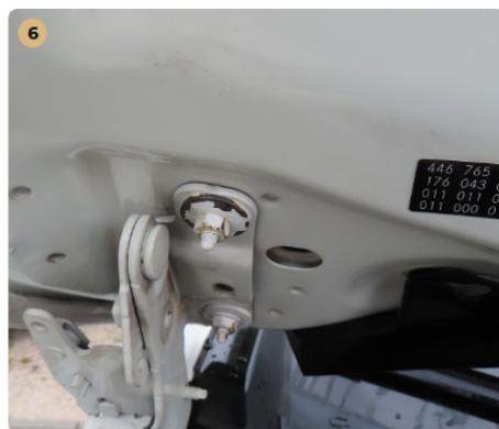
⚠ Külső karosszéria elemek Motorháztető és a sárvédő csavarjain megbontás jelei láthatók.
