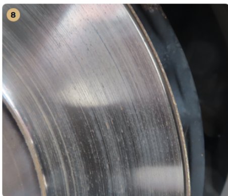
⚠ Féktrendszer A féktárcsán kezdődő vállasodás található.
