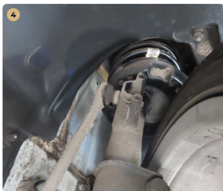
✓ Futómű A lengéscsillapítón olajfolyás nem észlelhető.
