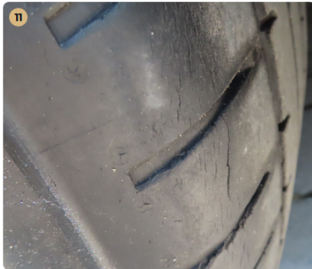
⚠ Gumiabroncsok A gumiabroncsok odalfala repedezett.
