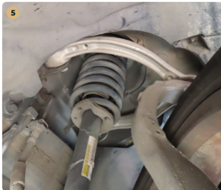
✓ Futómű A lengéscsillapítón olajfolyás nem észlelhető.
