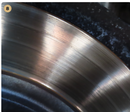
✓ Fékrendszer A féktárcsa megfelelő állapotban van.
