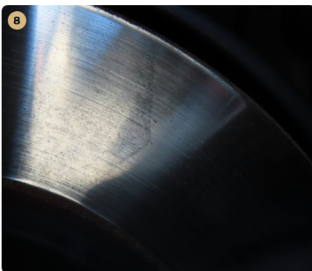
✓ Féktrendszer A féktárcsa megfelelő állapotban van.
