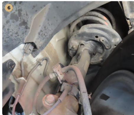
✓ Futómű A lengéscsillapítón olajfolyás nem észlelhető.
