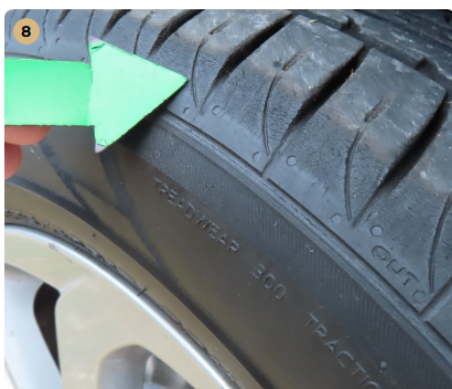
! Gumiabroncsok A gumiabroncsok odalfala repedezett.
