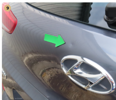
! Külső karosszéria elemek Az autó használatából eredő apró kavicsfelverődések, hajsza karcok láthatóak. Csomagtér ajtón kisebb horpadás van.
