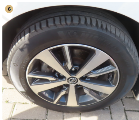
✓ Gumiabroncsok A gumiabroncsok odalfala nem repedezett.
