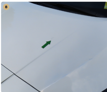
! Külső karosszéria elemek Motorháztetőn több horpadás is látható.
