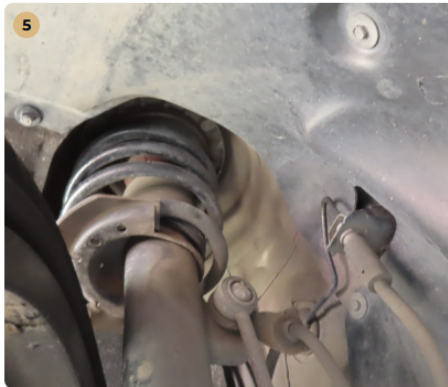
✓ Futómű A lengéscsillapítón olajfolyás nem észlelhető.
