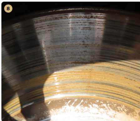
⚠ Féktrendszer A féktárcsán kezdődő vállasodás található.
