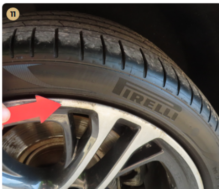
⚠ Felnik Könnyűfém felnin patkázás nyomai láthatóak.
