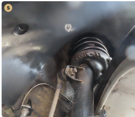
5 Futómű A lengéscsillapítón olajfolyás nem észlelhető.
