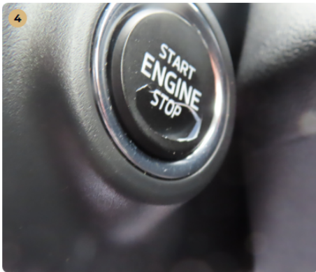
4 Kárpitozás és belső burkolatok Indító gomb törött, de funkcionál.
