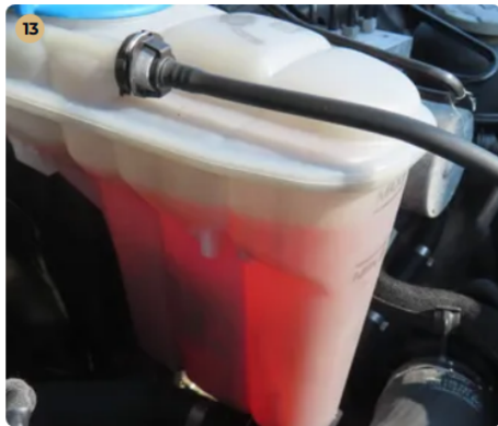
✓ Motor A hűtőfolyadék szintje megfelelő.
