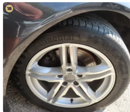
✓ Gumiabroncsok A gumiabroncsok odalfala nem repedezett.
