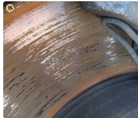
✓ Féktárcsa Féktárcsán állásból adódóan felületi korrózió látható, ami rövid használat után lekopik. Első féktárcsáknak enyhe válla van.
