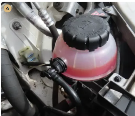
✓ Motor A hűtőfolyadék színe megfelelő.
