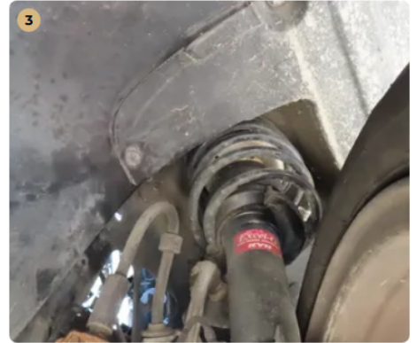
✓ Futómű A lengéscillapítón olajfolyás nem észlelhető.
