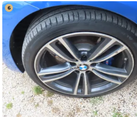
✓ Gumiabroncsok A gumiabroncsok odalfala nem repedezett.
