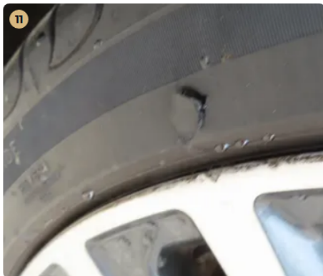
⚠ Gumiabroncsok Jobb hátsó gumiabroncs oldalfala szakadt.
