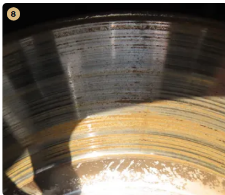
! Fékrendszer A féktárcsán kezdődő vállasodás található.
