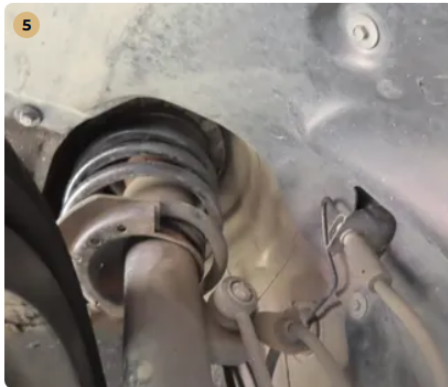
✓ Futómű A lengéscsillapítón olajfolyás nem észlelhető.
