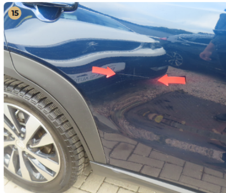
! Külső karosszéria elemek Az autó használatából eredő apró kavicsfelverődések, hajsza! karcok láthatóak. Jobb hátsó ajtón mélyebb karc van.
