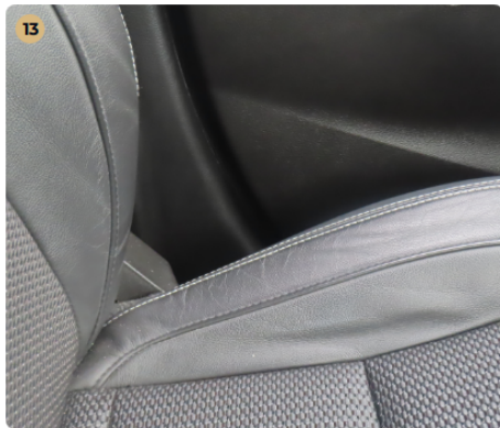
! Kárpitozás és belső burkolatok Vezető oldali ülés enyhén repedezett.
