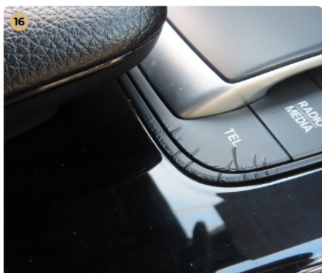
! Kárpitozás és belső burkolatok Közép konzolon minimális kopás van.
