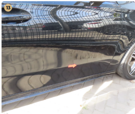
! Külső karosszéria elemek Az autó használatából eredő apró kavicsfelverődések, hajsza karcok láthatóak. Jobb első ajtón 2 horpadás van.
