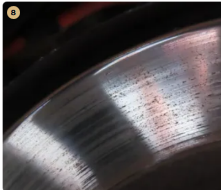
⚠ Féktrendszer A féktárcsán kezdődő vállasodás található.
