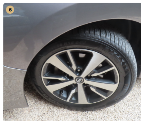
✓ Gumiabroncsok A gumiabroncsok odalfala nem repedezett.
