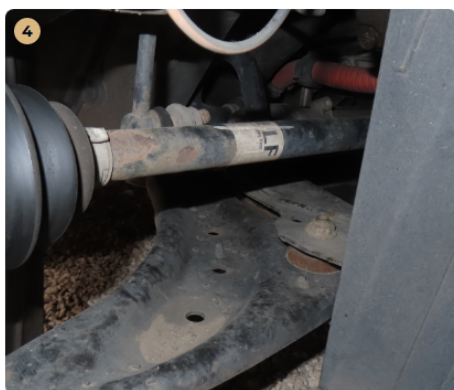
✓ Futómű A féltengelyen zsíros / olajos kicsapódás nem látható.
