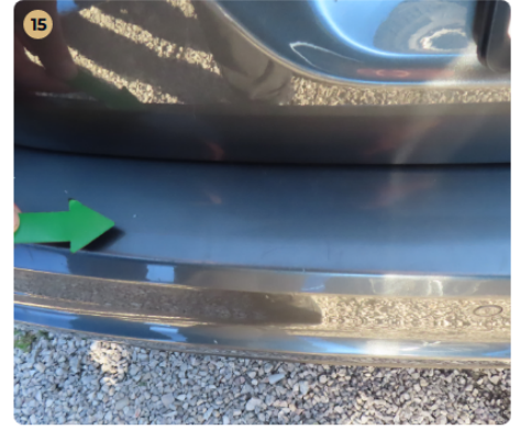
15 Külső karosszéria elemek Az autó használatából eredő apró kavicsfelverődések, hajsza karcok láthatóak.
