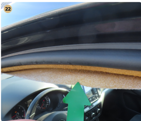
22 Kárpitozás és belső burkolatok Tető kárpit a vezető ajtónál lóg.
