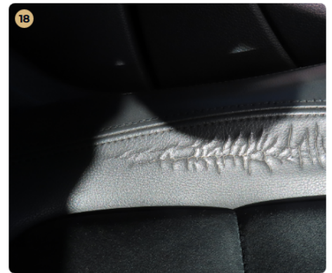
18 Kárpitozás és belső burkolatok Vezető ülés oldalán kopás, repedés látható.
