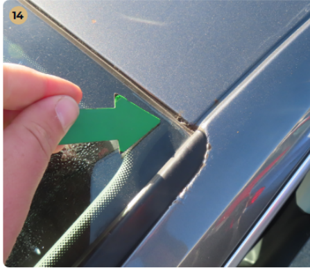
14 Külső karosszéria elemek Szélvédőnél kisebb korrózió figyelhető meg.
