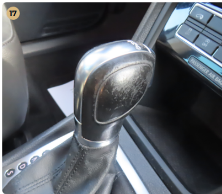
17 Kárpitozás és belső burkolatok A váltó gomb kopott.
