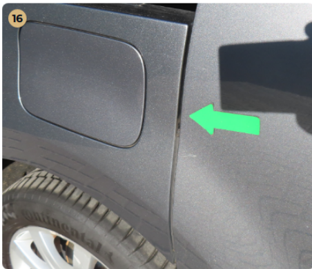
16 Külső karosszéria elemek Az újrafényezett elemeknél szín eltérés figyelhető meg.
