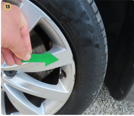
13 Felnik Könnyűfém felnin patkázás nyomai láthatóak.
