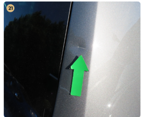
21 Külső karosszéria elemek Az autó használatából eredő apró kavicsfelverődések, hajsza karcok láthatóak. Csomagtér ajtón fénysérülések és horpadás látható.
