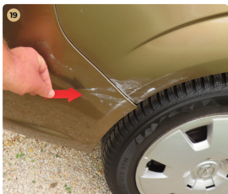
! Külső karosszéria elemek Hátsó véshárító és jobb hátsó sárvédő horzsolts.
