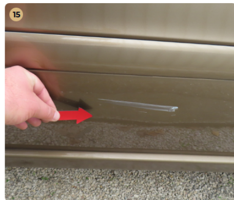
! Külső karosszéria elemek Bal hátsó ajtón horpadás, horzsolás látható.
