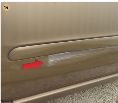
! Külső karosszéria elemek Bal első ajtón nagyobb horpadás, horzsolás látható.
