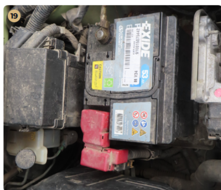
✓ Elektromos berendezések Akkumulátor nem gyári, már cserélt.
