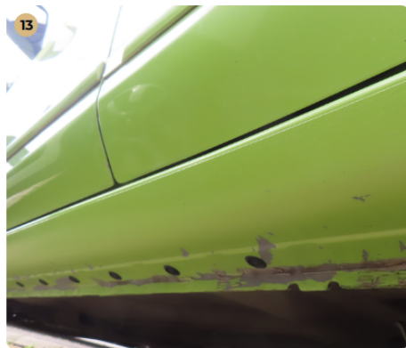
! Külső karosszéria elemek Küszöbön fénysérülések láthatók.
