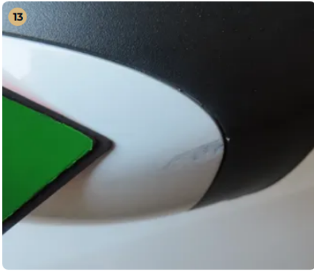
! Külső karosszéria elemek Visszapillantó tükör burkolatok horzsoltak.
