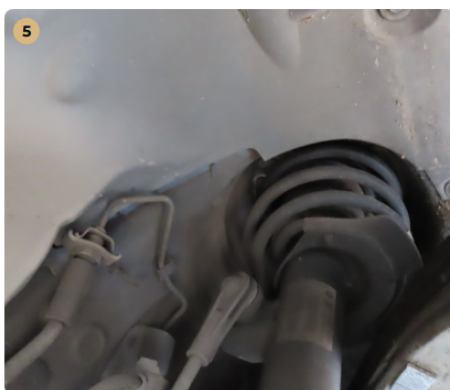
✓ Futómű A lengéscsillapítón olajfolyás nem észlelhető.
