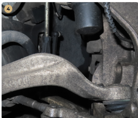
✓ Futómű A futóművön rozsdásodás / korrózió nem látható.
