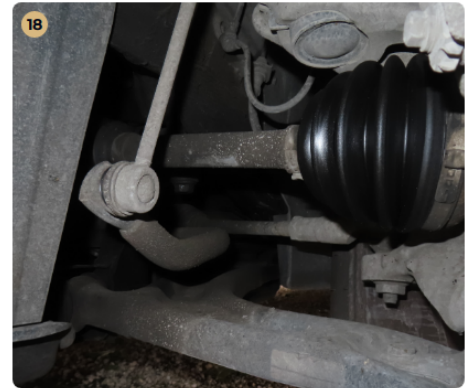
✓ Futómű A gumiharangokon szakadás, repedés nem látható.
