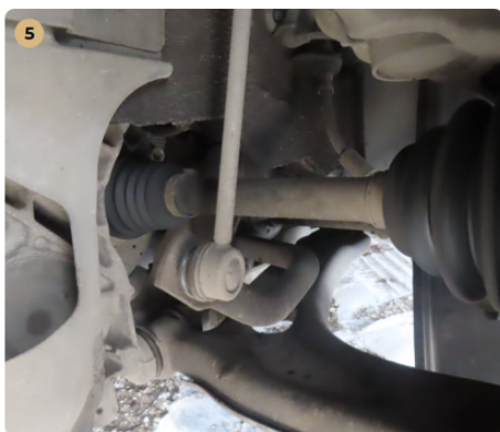
5 Futómű A féltengelyen zsíros / olajos kicsapódás nem látható.
