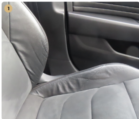
1 Kárpitozás és belső burkolatok Vezető ülés oldalsó része enyhén kopott.
