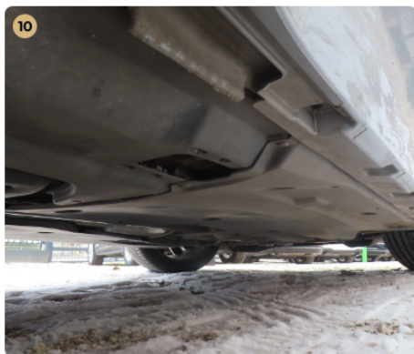
10 Utascella és gyűrődő zónák A küszöbökön javításra utaló nyomok nem észlelhetők.
