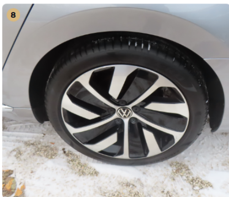
8 Gumiabroncsok A gumi oldalfalán, szálszakadás jele (dudor) nem található.
