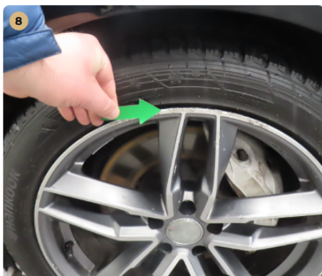
8 Felnik Könnyűfém felnin patkázás nyomai láthatóak.
