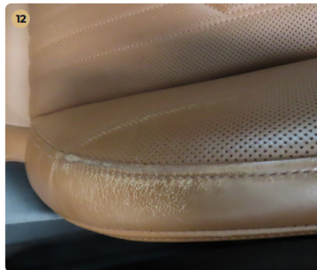
12 Kárpitozás és belső burkolatok Vezető ülésen kopás látható.
