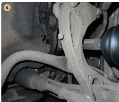
4 Futómű A féltengelyen zsíros / olajos kicsapódás nem látható.
