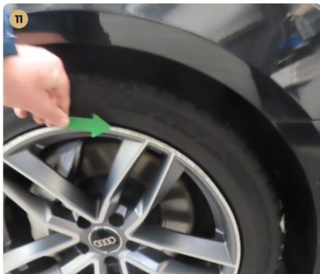
11 Felnik Könnyűfém felnin patkázás nyomai láthatóak.
