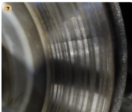
7 Fékrendszer Féktárcsán állásból adódóan felületi korrózió látható, ami rövid használat után lekopik.
