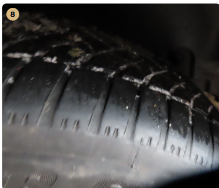
⚠ Gumiabroncsok A gumiabroncsok odalfala repedezett.
