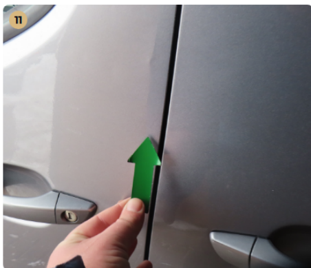
⚠ Külső karosszéria elemek Bal első ajtón horpadás, fény sérülés látható.
