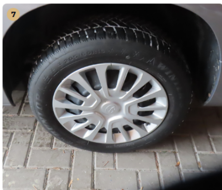
⚠ Gumiabroncsok A gumiabroncsok odalfala repedezett.
