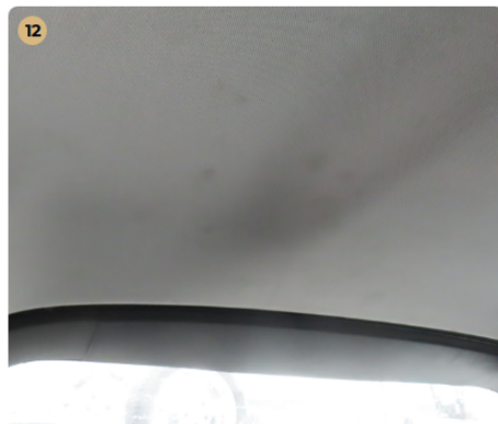
⚠ Kárpitozás és belső burkolatok Tetőkárpit szennyezett.
