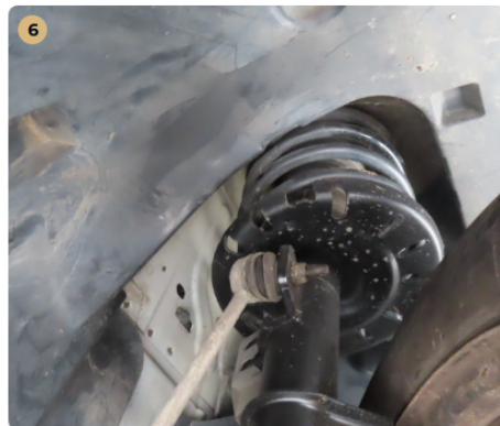
✓ Futómű A lengéscsillapítón olajfolyás nem észlelhető.
