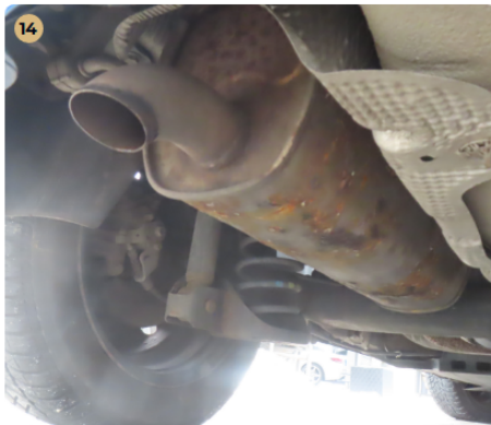
! Motor Hátsó kipufogó dob palástja korrodált.
