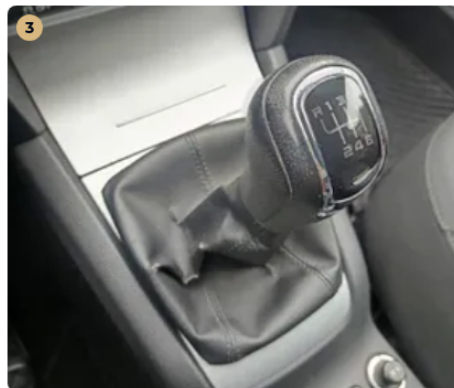
⚠ Kárpitozás és belső burkolatok Váltó szoknya repedezett.
