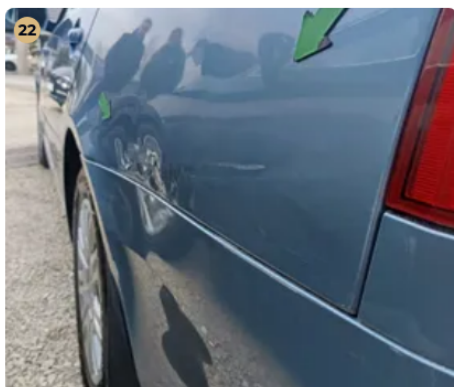
Külső karosszéria elemek Bal hátsó sárvédőn szakszerűtlen javítás látható.
