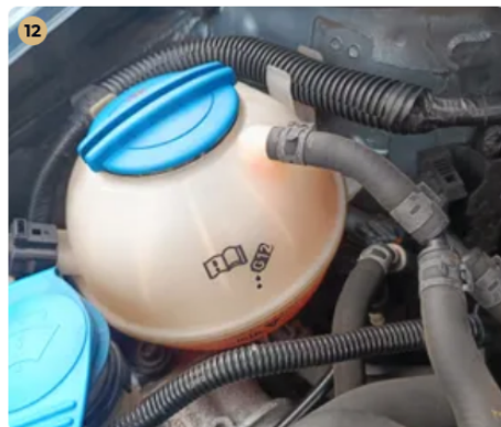
✓ Motor Hűtőfolyadékszint megfelelő.
