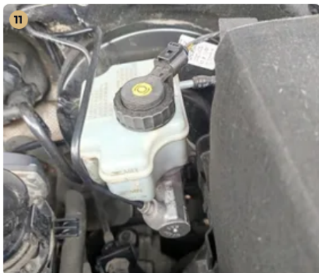
✓ Fékrendszer A fékfolyadék színe megfelelő.
