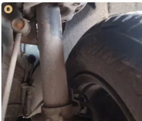
✓ Futómű A lengéscsillapítón olajfolyás nem észlelhető.
